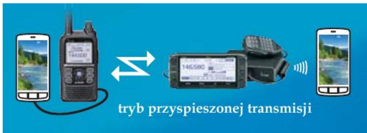
Rys. 5.5. Transmisja danych między radiostacjami D-Starowymi. Jeżeli obie stacje są wyposażone w program D-RATS możliwa jest bezpośrednia wymiana poczty elektronicznej, a jeżeli jedna z nich dysponuje połączeniem z Internetem – także przesyłanie wiadomości pod adresy internetowe
