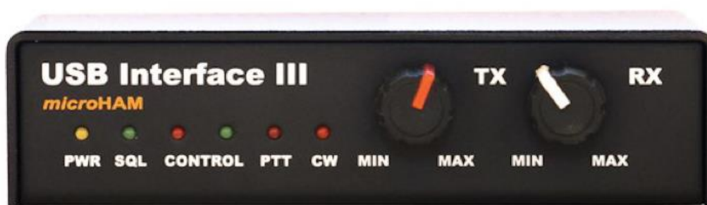
Fot. 1.4.1. Układ łączący radiostację z komputerem. Przedstawiony model posiada wbudowany podsystem dźwiękowy. Jest on podłączany przez złącze USB do komputera i do gniazdka danych radiostacji. Do popularnych modeli należy także Signalink USB
