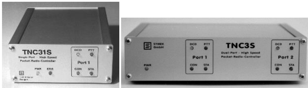
Fot. 2.4.2 i 4.2.3. TNC31S i TNC3S firmy „Symek” [2.3]. W obu można zainstalować modemy 1200 i 9600 bit/s – odpowiednio pojedynczy modem lub dwa równocześnie
